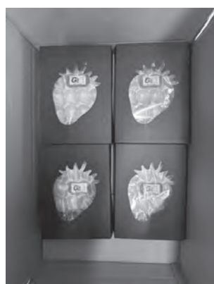
包装容器内への加速度センサー配置の様子
